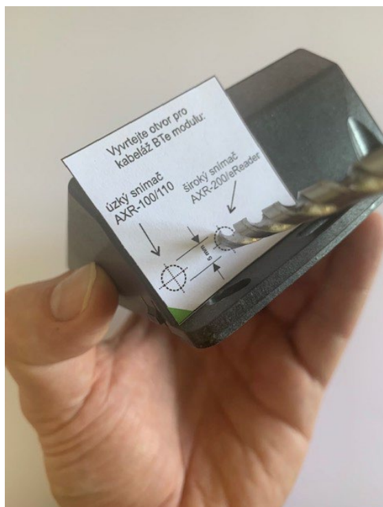
Obr. Vrtání otvoru pro široký kryt (ER, AXR-2xx)
